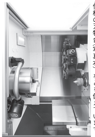
全箇所回転工具の取り付け可能なミリーング仕様の刃物台(写真右)などを備えています
